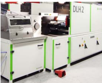
Drahtlackiermaschinen für den Drahtbereich von 0,015 – 1,25 mm Ø
